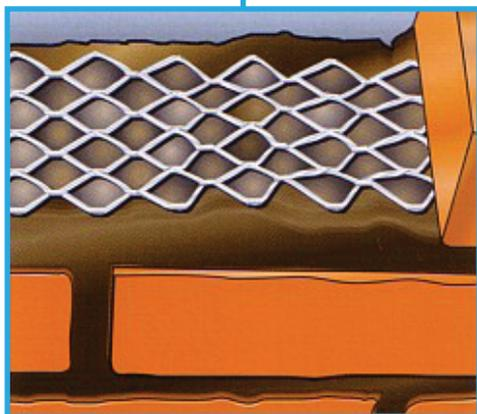
鼎达盘管钢板网以嵌入砖墙和砌块墙之间的灰浆，作为加强的效果。它也适合用为输送管道和设施网上的加筋涂灰泥。
