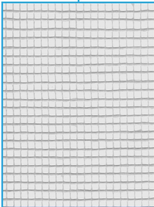
鼎达玻纤网卷广泛用于干砌墙罩面层泥灰加固和蒸压加气混凝土 (AAC) 砌块墙应用中，如接缝、角落和裂缝的修补/预防。
